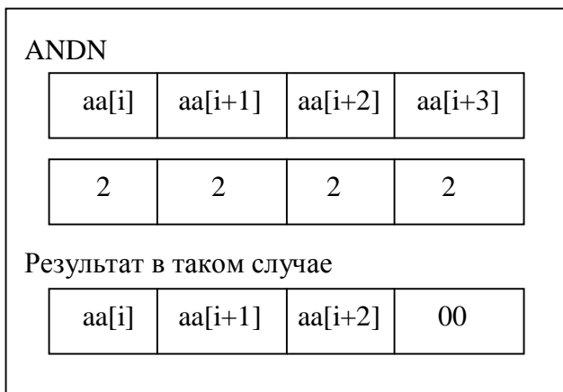
Рис. 10. Пример работы операции ANDN
